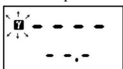
Для сброса накопленного значения импульсов счета и возобновления накопления сначала необходимо нажать и удерживать кнопку MODE, находясь в данном режиме.
