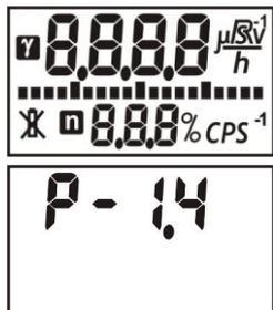
Сразу после включения должна включиться подсветка ЖКИ и высветиться все сегменты ЖКИ, одновременно, примерно на 1 с, должна включиться сигнализация (звуковая и/или вибрационная), дозиметр должен перейти в *режим тестирования* (2.2.3.1). В *режиме тестирования* на ЖКИ, в течение нескольких секунд, индицируется номер программной версии (P-1.4).
