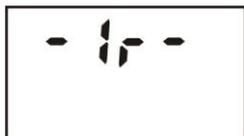
Для включения *режима связи с ПК* необходимо окно ИК приемопередатчика дозиметра и окно адаптера ИК (IrDA) канала связи направить друг на друга, расположив их на расстоянии не более 15 см и нажать кнопку LIGHT. Как только дозиметр войдет в режим обмена информацией на ЖКИ высветится сообщение "-Ir-".
