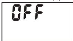
**Внимание!** Дозиметр автоматически выключается (на ЖКИ индицируется надпись "OFF") после считывания истории работы дозиметра в режиме связи с ПК.
