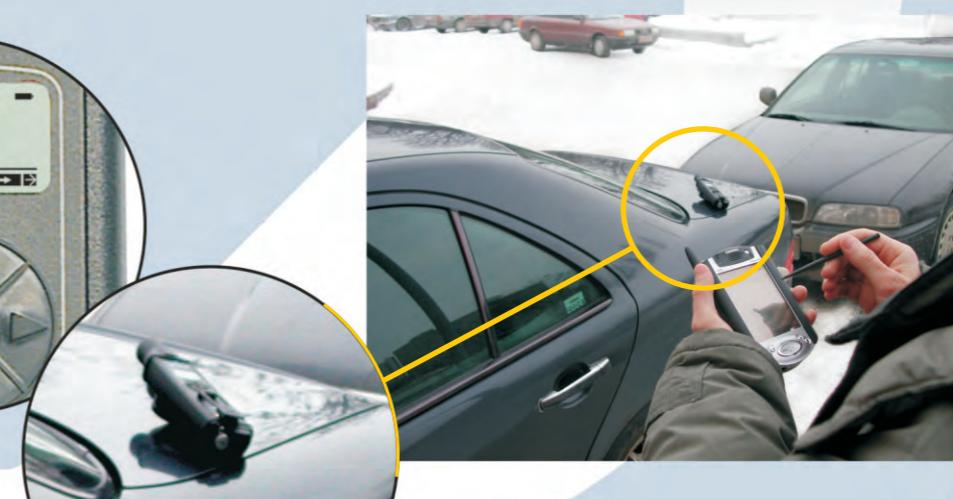
Использование радиоканала Bluetooth и миникомпьютера позволяет производить измерения и идентификацию на безопасном для пользователей расстоянии от источника излучения.
