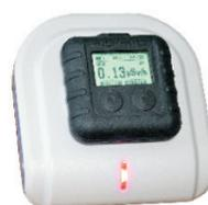
PM1610-01/PM1610A-01 - версия прибора для использования с различными типами беспроводных ридеров, соответствующих стандарту ISO 15693.
